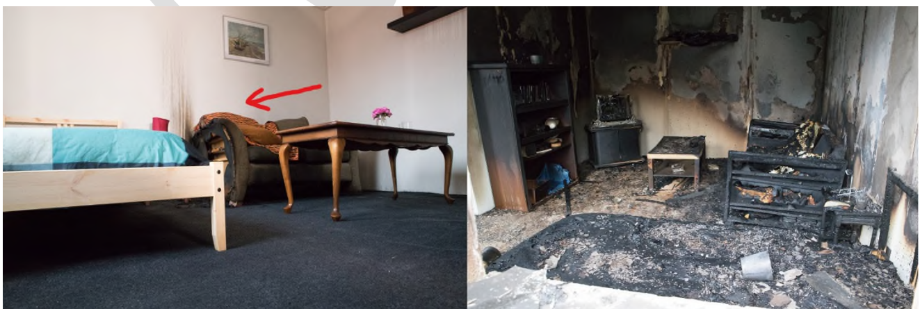
Figuur 11a en b: brand geblust door sprinkler (links) in vergelijking met dezelfde situatie zonder sprinklers (rechts)
