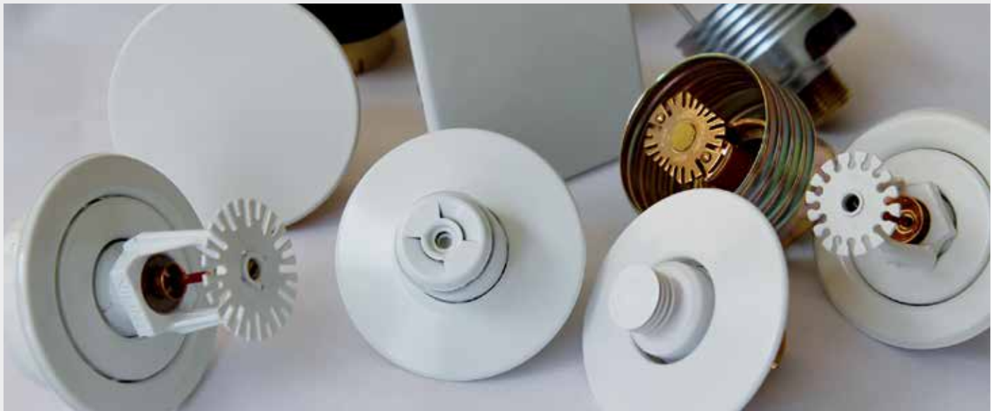
DIVERSE UITVOERINGEN SPRINKLERKOPPEN. LINKS EN RECHTS STANDAARD WONINGS-PRINKLERS. IN MIDDEN TWEE TYPE FLUSH SPRINKLERS MET VERZONKEN SPRINKLERKOP DIE DOOR WARMTE UIT PLAFOND KOMT. OP ACHTERGROND DE CONCEALED (VERZONDEN SPRINKLERKOP) ZONDER DEKSEL.
