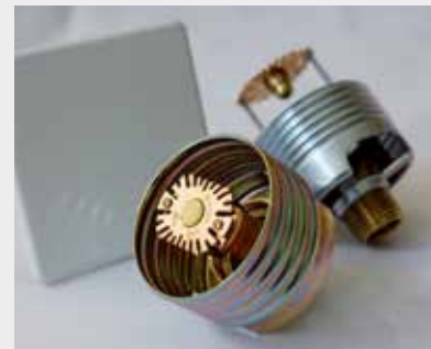
CONCEALED SPRINKLERS KUNNEN IN VERLAAGDE PLAFONDS WORDEN TOEGEPAST. ALLEEN HET AFDEKPLAATJE IS ZICHTBAAR. BIJ BRAND KOMT HET PLAATJE LOS EN KOMT DE SPRINKLERKOP UIT HET PLAFOND.
